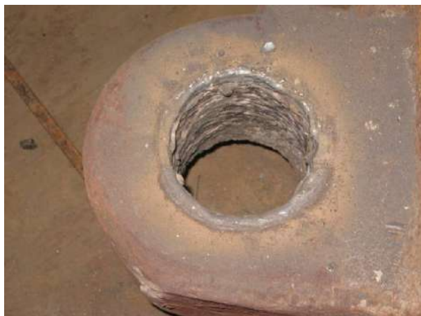
Slika 3. Otvor u segmentu posle navarivanja
