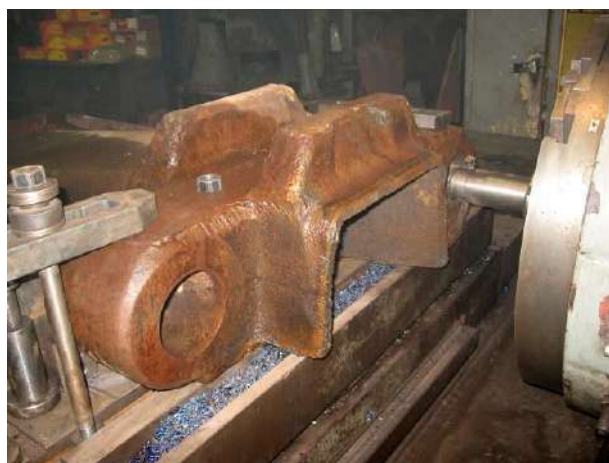
Slika 4. Obrada navarenih otvora na borverku
