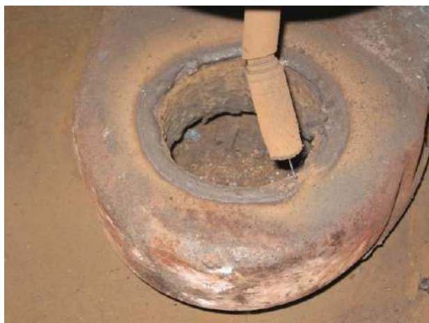
Slika 2. Navarivanje pohabanog otvora
